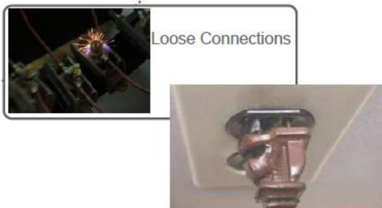
图 5：接触不良产生串弧
