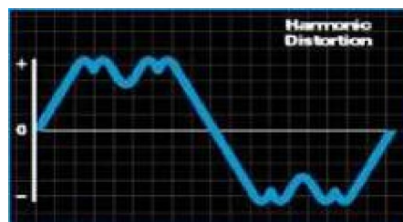
图 2.12 含有谐波的交流电波形
