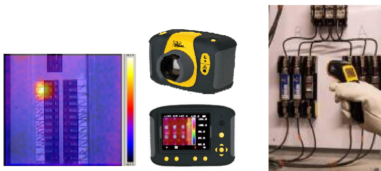
图 2.1 使用 IDEAL 热像仪和红外线测温仪测量电气线路高热点
